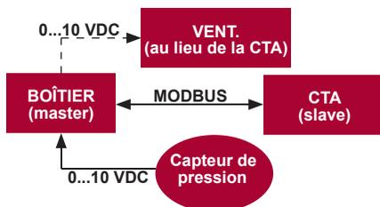
Ce boîtier permet de contrôler le niveau de CO2 de l'ambiance. Il suffit de connecter au boîtier la sonde de CO2 0..10VDC et de configurer le boîtier. Dans le régime « service » régler le point F.14 sur 2 et définir et F.15 et F.16 en fonction de la spécification de la sonde.
