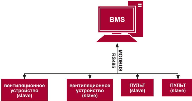
**3) Управление вентилятором, если скорость устанавливается с помощью пульта и/или компьютера через Modbus**
