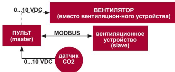
С помощью данного пульта можно управлять уровнем углекислого газа (CO2) в помещении. Просто к самому пульту нужно подключить датчик CO2 0...10VDC и сконфигурировать пульт. В служебном режиме в пункте F.14 необходимо выставить 2, а F.15 и F.16 настроить в соответствии со спецификацией датчика.
