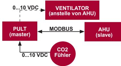
Mit Hilfe dieses Pults kann Niveau des Kohlendioxids (CO2) im Raum gesteuert werden. Am selben Pult muss der 0..10VDC-Fühler für CO2 angeschlossen und das Pult konfiguriert werden. Im Punkt F.14 des Servicebetriebs muss die Zahl 2 eingestellt werden, und in F.15 und F.16 wird sie laut Beschreibung des Fühlers angegeben.
